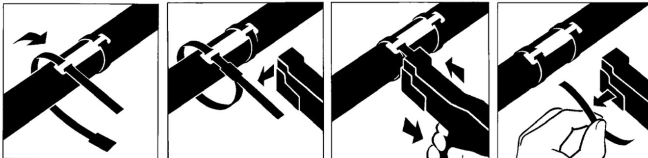
ИНСТРУМЕНТ ДЛЯ МОНТАЖА СТАЛЬНЫХ КАБЕЛЬНЫХ ХОМУТОВ:
