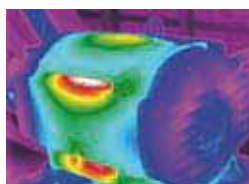
Аномальный или неравномерный нагрев двигателя
